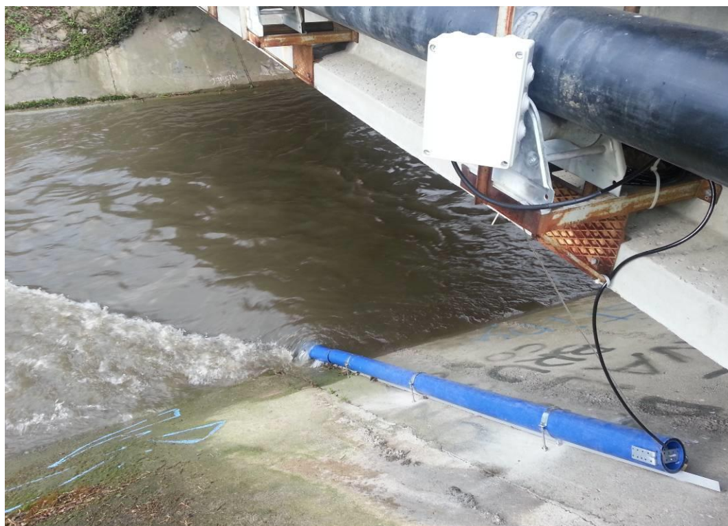
Figura 51 – Installazione della sonda S/N 13M101704 all'interno del CSNO
