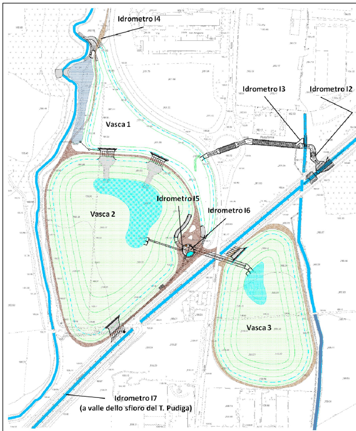
Figura 41 - Vasche di laminazione in progetto. Posizionamento idrometri
