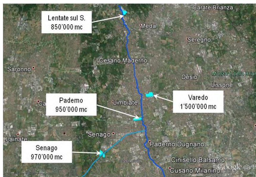
Figura 8 – Invasi di laminazione in scavo da Lentate sul Seveso al CSNO (come da Studio-AIPO-2011) - (estratto dal doc. "A.1 Relazione Generale" allegato al progetto definitivo approvato).
